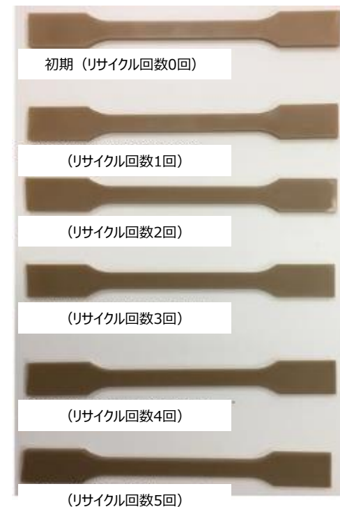
CNFRPの工程内リサイクル性検証サンプル
